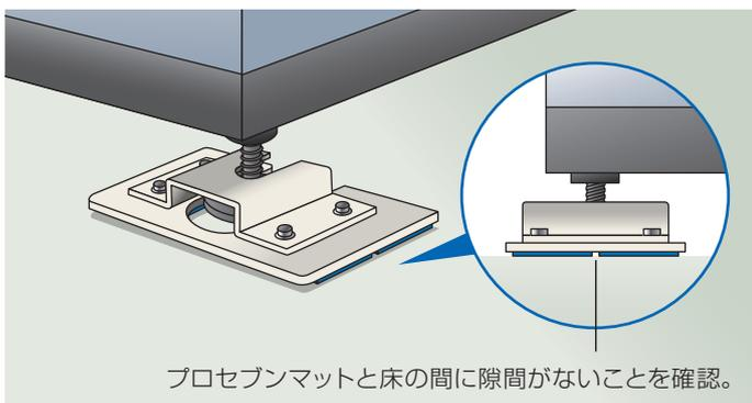
プロセブンマットと床の間に隙間がないことを確認。
