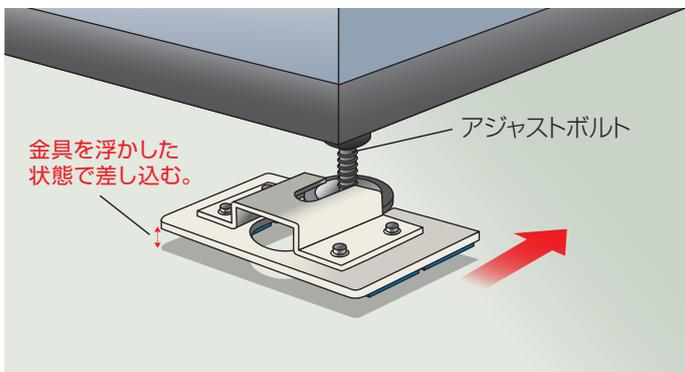
**4** 金具の側面から見て、プロセブンマットと床の間に隙間がないことを確認し、設置完了。
