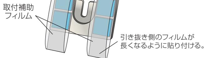
**3** 取付ける床面が乾いていることを確認し、金具を床面に置き、そのままスライドさせ、アジャストボルトの奥まで差し込みます。
