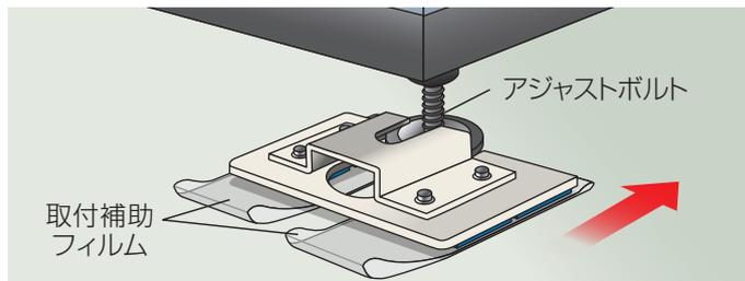
**4** 金具がズレないように上から軽く押さえながら、取付補助フィルムの下辺側だけをつまみ、ゆっくり手前に引いてフィルムを抜きます。
